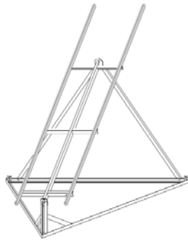
DEGER TOPtraker® 8.5 sin fundaciones de hormigón para montaje en tejado plano
